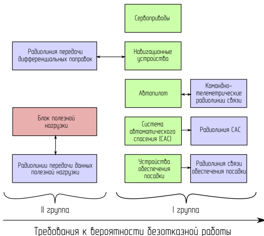
Рисунок 2 – Упрощенная классификация оборудования БПЛА по требованиям к вероятности безотказной работы
