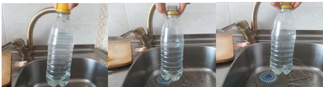
1-сурет – Атмосфералық қысымды баклажканы пайдаланып анықтау
