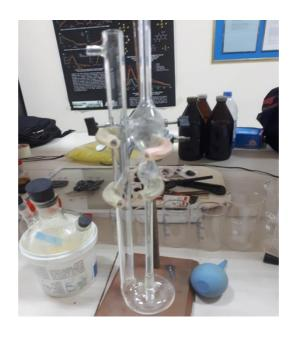
Рис.2 – Вискозиметр ВПЖ-4 для измерения относительной вязкости.
