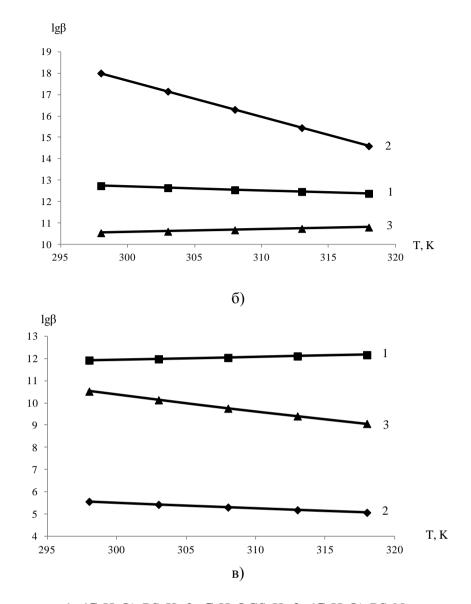
$1-(C_4H_9O)_2PS_2K; 2-C_4H_9OCS_2K; 3-(C_4H_9O)_2PS_2Na$  Рисунок 1 - Изменение констант устойчивости комплексов ионов металлов подгруппы железа при влиянии температуры с собирателями a)  $Fe^{2+}$ , б)  $Co^{2+}$ , в)  $Ni^{2+}$
