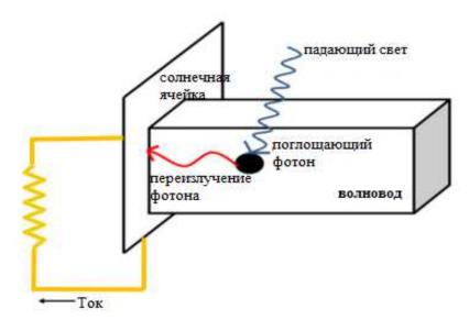
Рисунок 1 – Схема люминесцентного солнечного концентратора (ЛСК)
