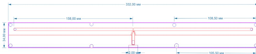
Рисунок 1 Чертеж изготавливаемой PCB — антенны
