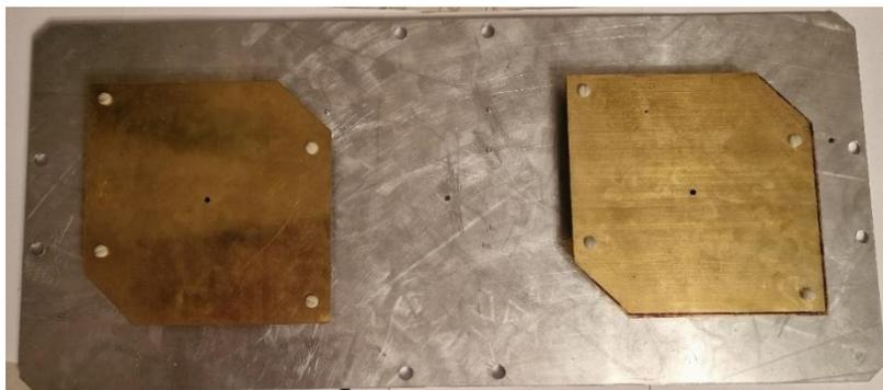
Рис.3 Вид изготовленной антенны спереди
