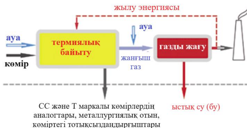
Сурет 2 – Ұшқыш заттардың жоғары шығымдылығымен көмірді термиялық байытудың схемалық схемасы
