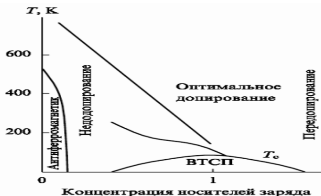
Сурет-2. Жоғарғы температурадағы асқынөткізгіштік күйінің келтірілген тасушылардың концентрациясынан тәуелділігінің жалпы диаграммасы
