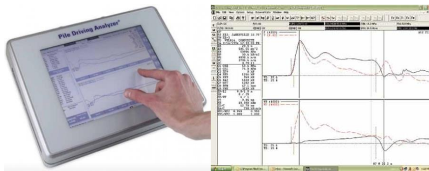
Рисунок 1 – Испытание сваи методом PDA
