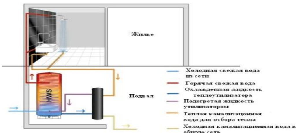
Рис. 1. Схема установки рекуперации тепла стоков
