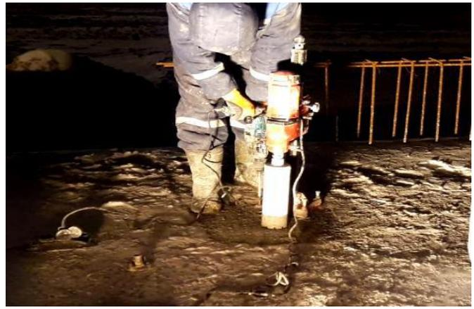
Рисунок 4. Отбор образцов бетона
