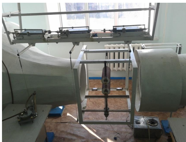
2 сурет – Кедір-бұдыр бетті цилиндрлер бекітілген аэродинамикалық құбырдың жұмыстық бөлігінің бейне суреті
