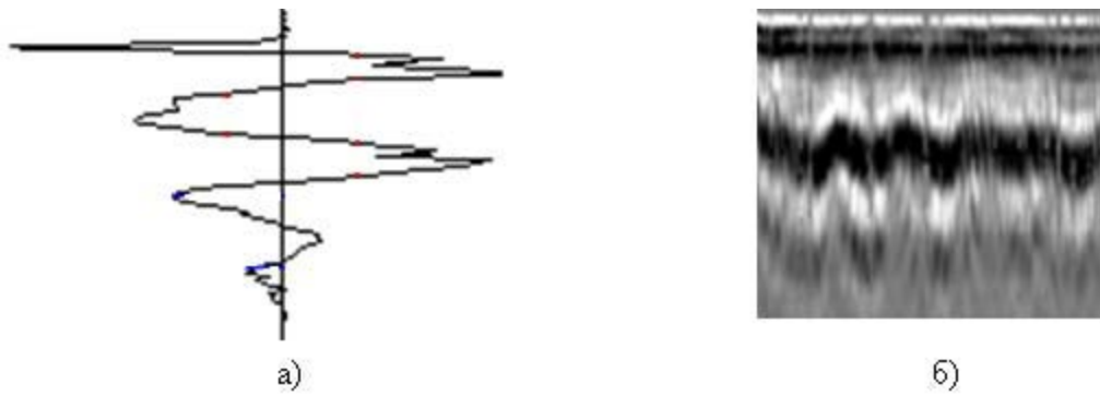
Сурет 1. Георадиолокациялық сигнал (а) және 30 МГц орталық жиіліктегі георадар көмегімен алынған профильдің фрагменті (б)
