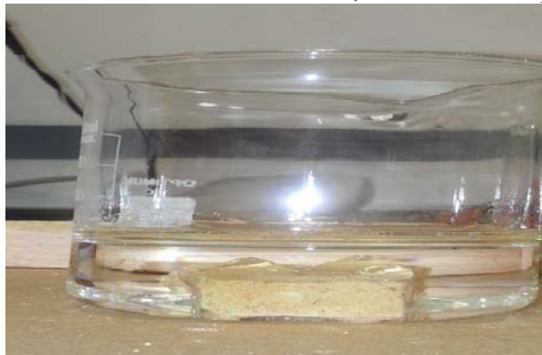
Рис. 5. Смачивание пористого материала в растворе воды и масло
