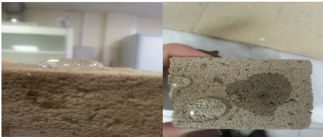
Рис.6- Проверка сорбирующего материала на гидрофобность после процесса-пиролиз
