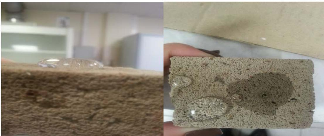
Рис.6- Проверка сорбирующего материала на гидрофобность после процесса-пиролиз
