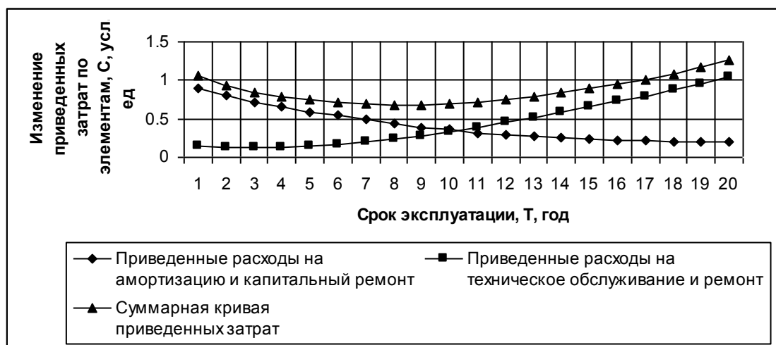
Рисунок 1.3 – Зависимость приведенных затрат от срока службы строительных машин
