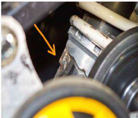
Сурет 1 – Қардажүргіштің жүріс бөлігінің бұзылуы: а) тіректерді кесу; б) рамадағы жарық
