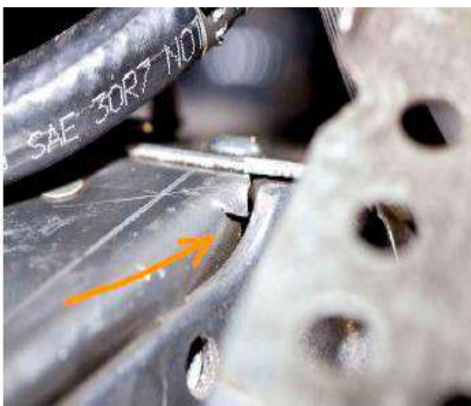
Сурет 1 – Қардажүргіштің жүріс бөлігінің бұзылуы: а) тіректерді кесу; б) рамадағы жарық
