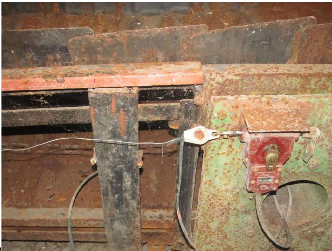
Сурет 2 – Шыңжырдың үзілуі кезіндегі жетегіндегі апатты түрде автоматты және қолмен сөндіру құрылғылары
