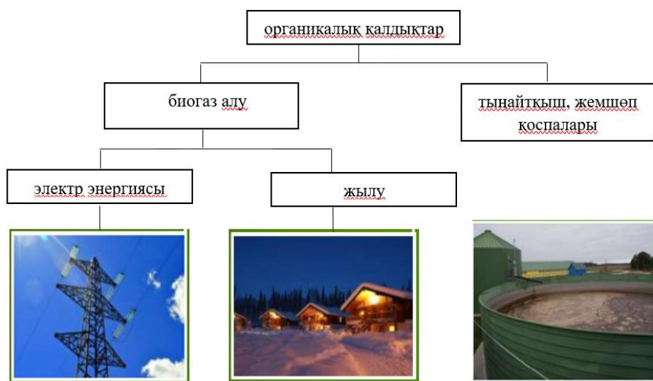
Сурет 1- Органикалық қалдықтардан биогаз түзілу схемасы
