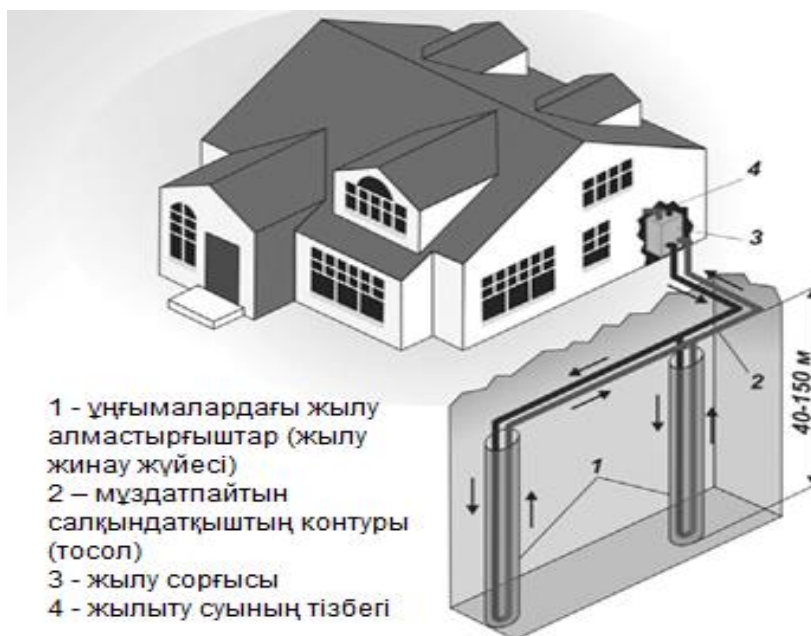
Сурет 1 - Жабық контурлы және екі тік топырақ алмастырғышы бар жылу сорғы станциясы негізінде автономды жылумен жабдықтау жүйесінің схемасы
