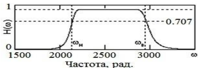
Рисунок.3.9– Передаточная характеристика фильтра Баттерворта
