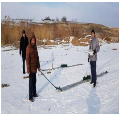
Рисунок 5.13 – Измерения к эксперимента №4, №5. а) Измерения антенной с разверткой – 3 (м). б) Измерения на холме антенной с разверткой – 0,5 (м)
