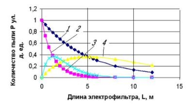
1,2 — экспериментальное распределение пыли в соответствии с формулой Дэйча; 3,4—фактическое распределение пыли; 1,4—при низкой степени очистки газов; 2,3 —при высокой степени очистки газов.
