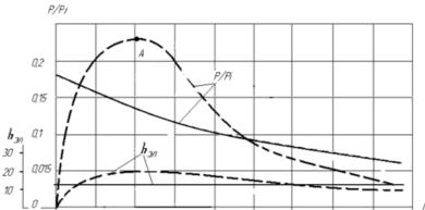
Р, Р - масса уловленной пыли соответственно на элементе и общая на электроде; - степень очистки газа на элементе электрода; - расчет; ---эксперимент
