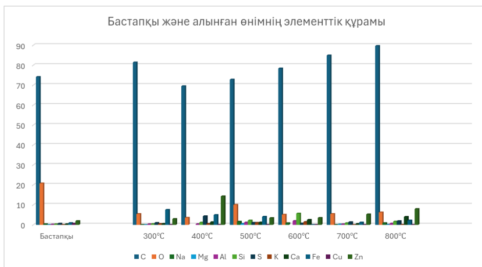
Сурет 3 Бастапқы тоқыма сымы мен белсендірілген адсорбенттің құрамы
