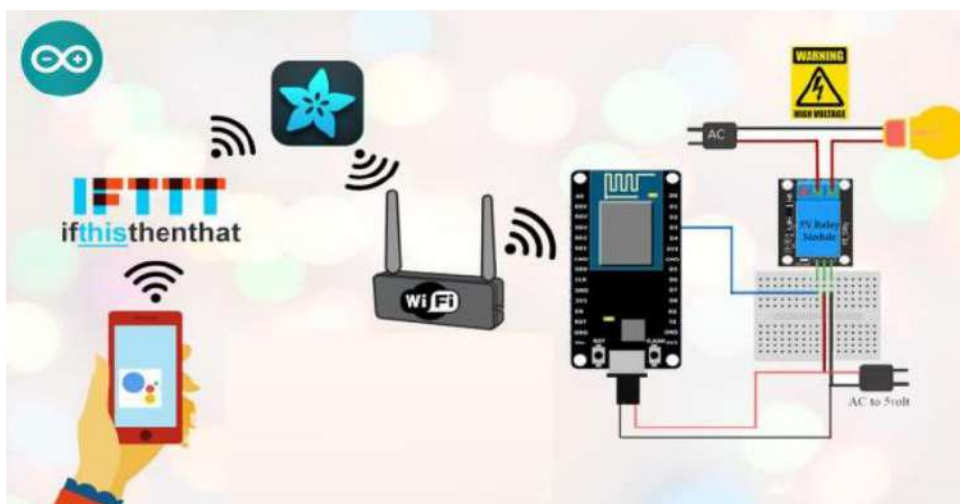
3 – сурет. Google assistant басқарылатын үй автоматикасының блок-схемасы[7].
