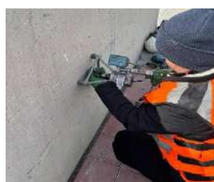
Рис 9, 10 определение прочности бетона методом отрыва со скалыванием
