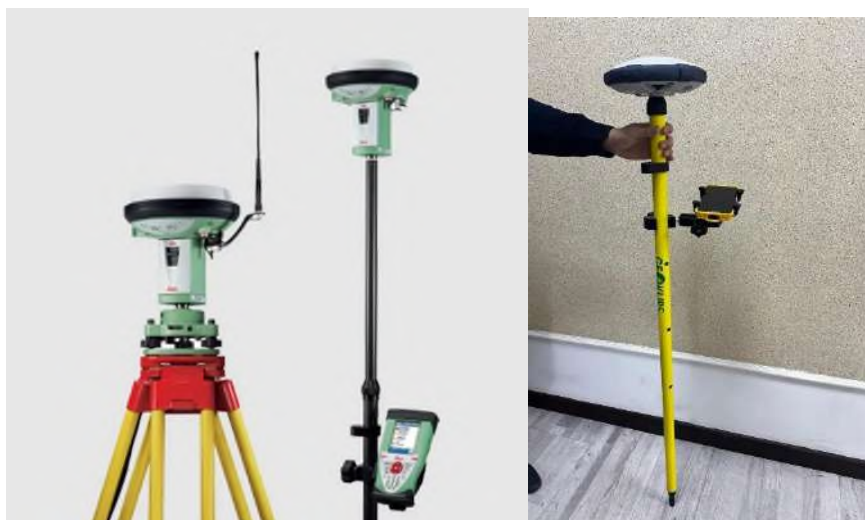
Рис. 3 - GPS Leica gs 15, GNSS приемник Spectra Geospatial SP60
