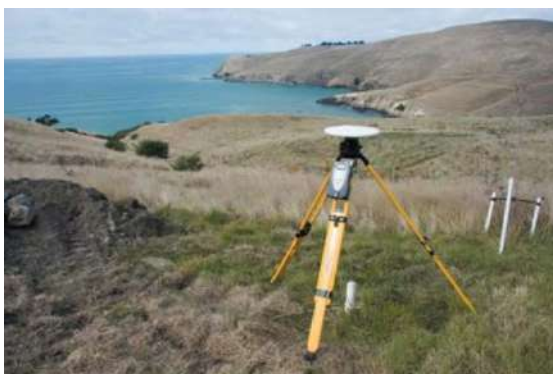
Сурет-4. Trimble R7 GNSS жерсеріктік қабылдағышы базалық станция ретінде.
