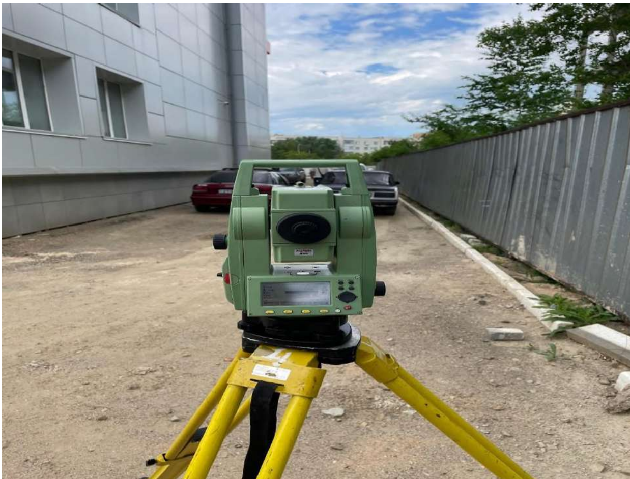
Сурет 3 Leica TS06 тахеометрімен түсіріс процесі
