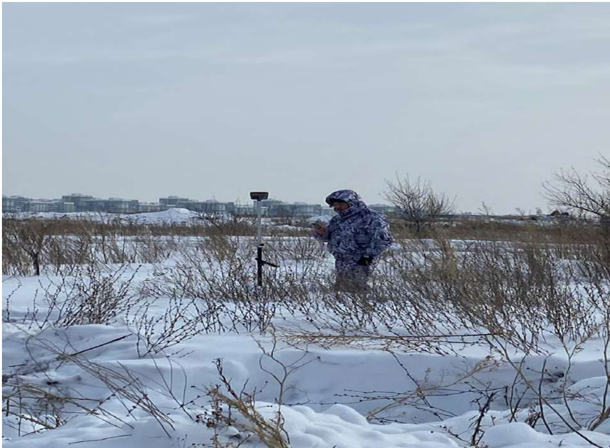
Сурет 2 South Galaxy G9 қабылдағышымен қардың жамылғысы өлшеу процесі
