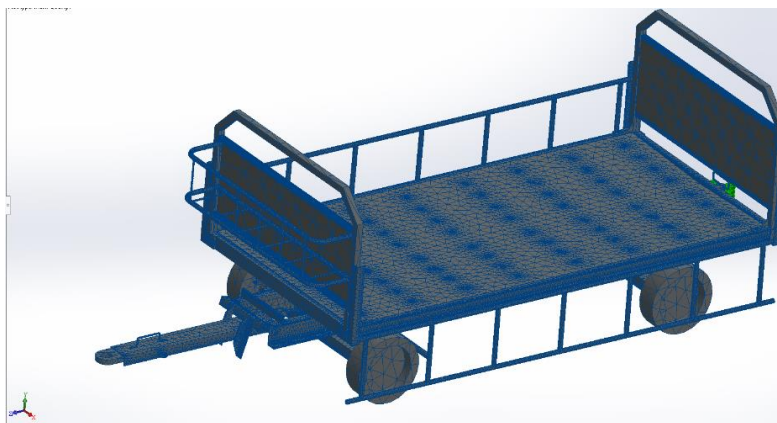
Рисунок 2 – Трехмерная конечно-элементная модель БАТ, выполненная в программе SolidWorks Simulation
