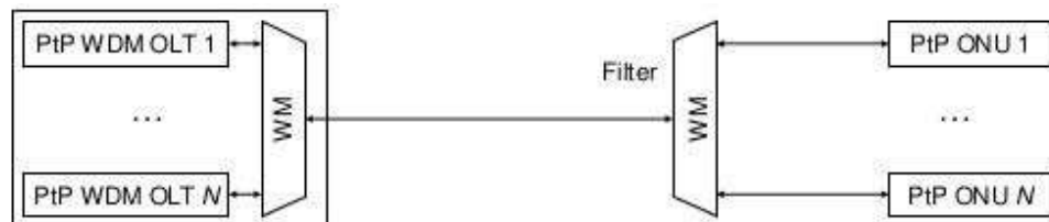
Рис.2. Принцип работы PtP WDM PON систем
