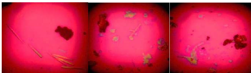
Рис. 2. Изображение микротрубок Cu после растворения полученное на рамановском микроскопе
