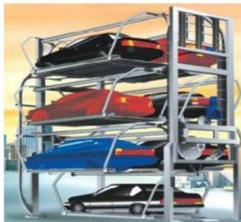
Рисунок 1- Схема принципа организации движения кабин в лифтовой системе, а так же принцип кругового перемещения платформ в роторной парковочной системе [2]
