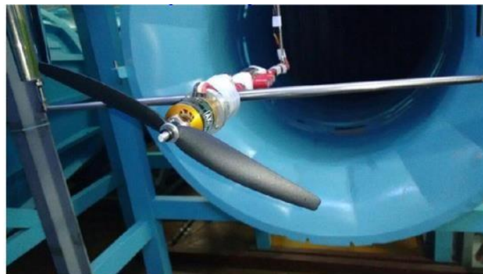
Сурет-4. Әуе винттерінің аэродинамикалық қасиеттерін алуға арналған эксперимент
