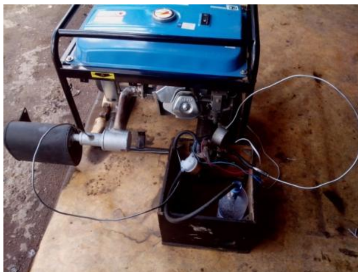
Рисунок 3 – Система питания ДВС на крекинг-газе на стационарном ДВС
