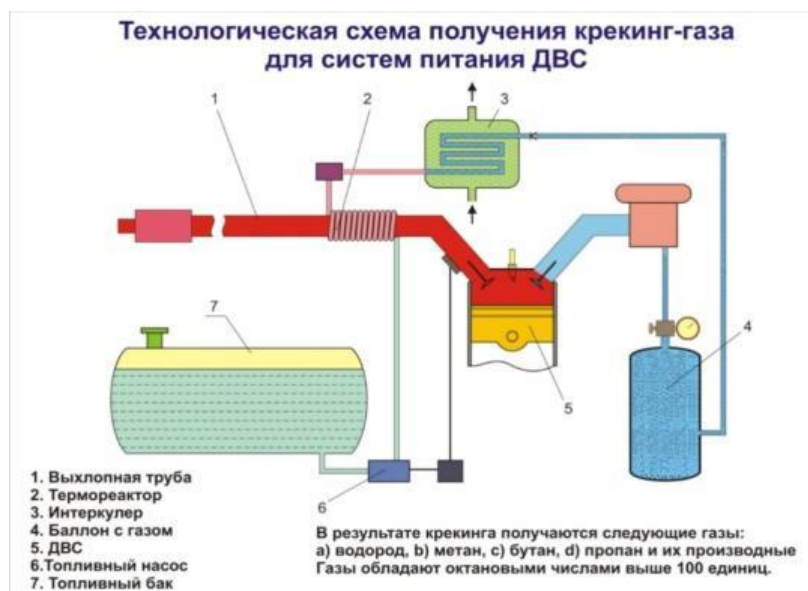
Рисунок 2 – Схема получения крекинг-газа на ДВС
