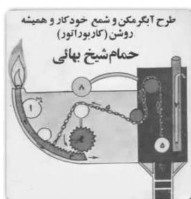
Рисунок 3. Схема механизма обогрева бани одной свечой
