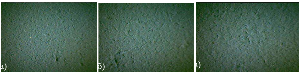
Рисунок 2. Фотографии поверхности электрода с наиболее оптимальным составом, после сушки, с разной толщиной нанесения 200, 400, 600 мкм по ракелю: А) 200 мкм; Б) 400 мкм; В) 600 мкм
