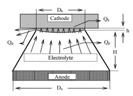
Рисунок 1 - Электролитная нагревающаяся плазма
