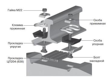
Рисунок 1. Общий вид конструкции скрепления ЖБР-65
