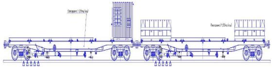
Рисунок 3 - Грузовые платформы диагностического комплекса СПМ-18
