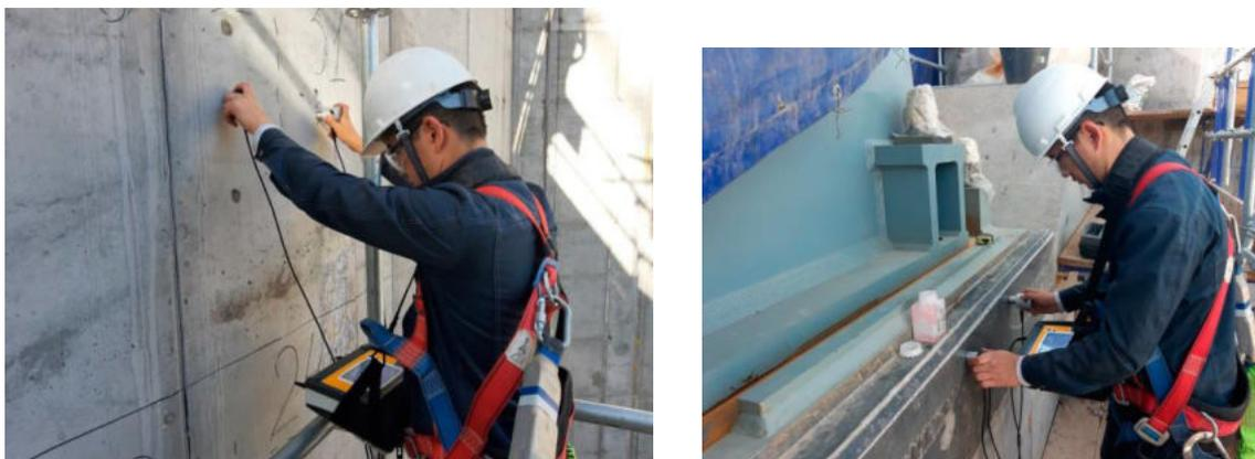
Рисунок 2. Определение глубины трещин ультразвуковым анализатором Pulsonic
