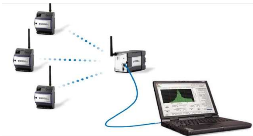
Рисунок 1. Шлюз NI WSN-9791 и узлы измерения NI WSN-3212
