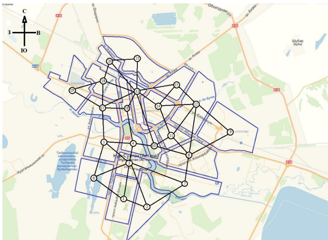
Рисунок 4.4 - Структура смежностей графа G ядра модели городской агломерации (на примере Астанинской городской агломерации)
