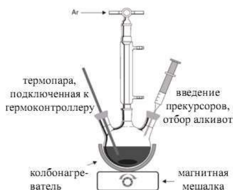
Рисунок 1. – Блок-схема установки для проведения синтеза квантовых точек
