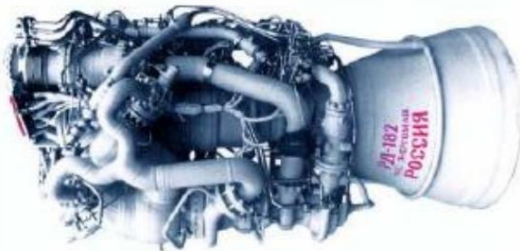
Сурет 1 - Күрделі көлемдік геометрияға ие «ЗК-182» қозғалтқышында құбыржелілердің ықшамдалып орналастырылуы
