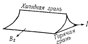
Фиг. 4.24. Форма образца для термомагнитного охлаждения.
