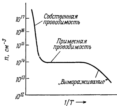
Фиг. 1.3. Схематическая зависимость концентрации носителей заряда от обратной температуры.
