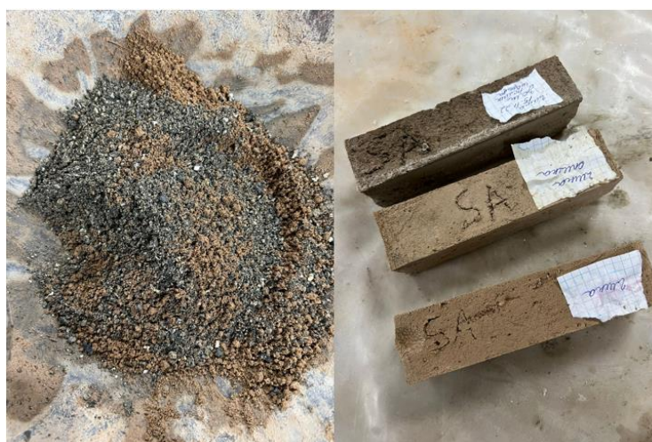
Сурет 1. Техногендік және табиғи шикізатты араластыру негізінде алынған массаның сыртқы түрі.
