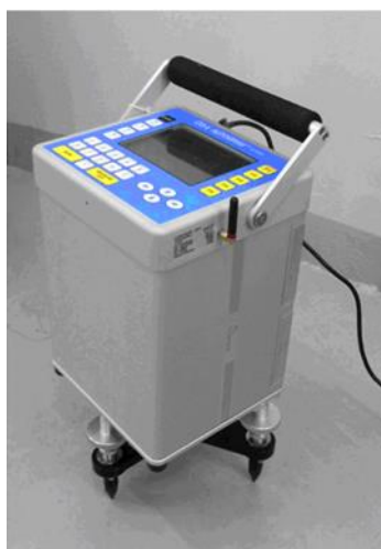
Сурет – 6. OSG типті стационарлық суперпро жүргізуші гравиметрі.
