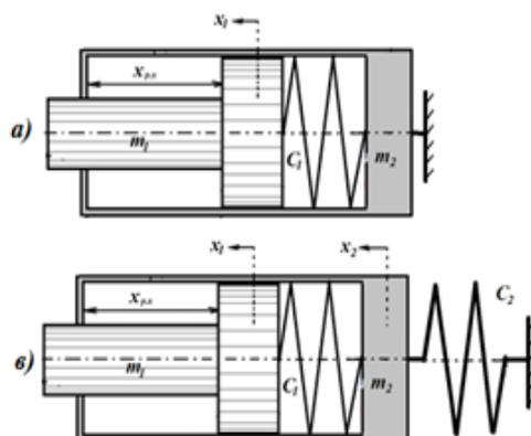
Рисунок 2 – а) корпус неподвижен; б) корпус подвижен за счет упругости навесного оборудования.
