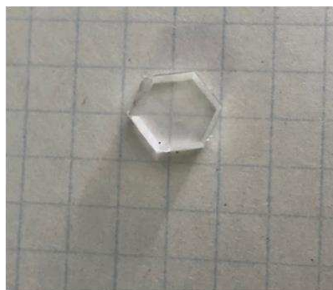
2-сурет – Сулы ерітіндіден баяу буландыру әдісімен өсірілген LiKSO_4 кристалдары.
