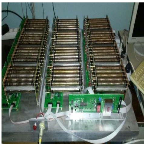
Сурет 1-“Ковер” ғарыштық сәулелер детекторының жалпы және сыртқы көрінісі
