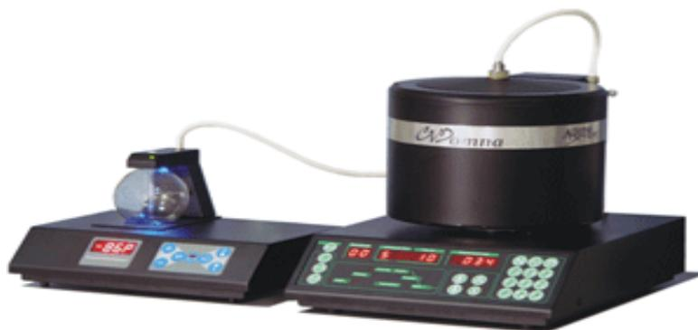
Рисунок 1- Установка для синтеза углеродных нанотрубок
